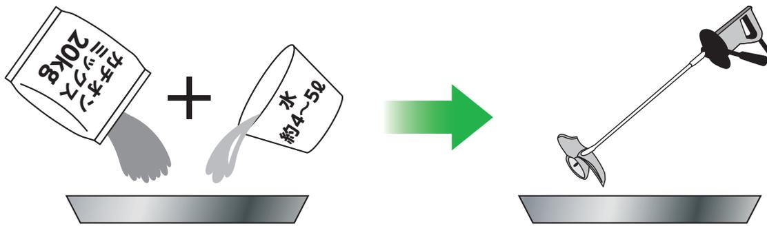
カチオンミックス全量(20kg)を練容器に入れて、水を4~5ℓ加え、パワーミキサー等で十分に攪拌して下さい。粘度は、下地に合わせ適量に調整してください。
